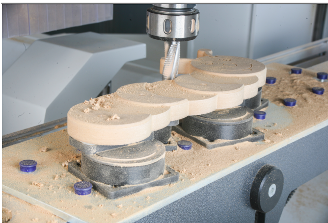
Plaques d'adaptation ISAP-K1 avec Mono-Base et blocs ventouses pour le bridage de pièces en bois courbées
